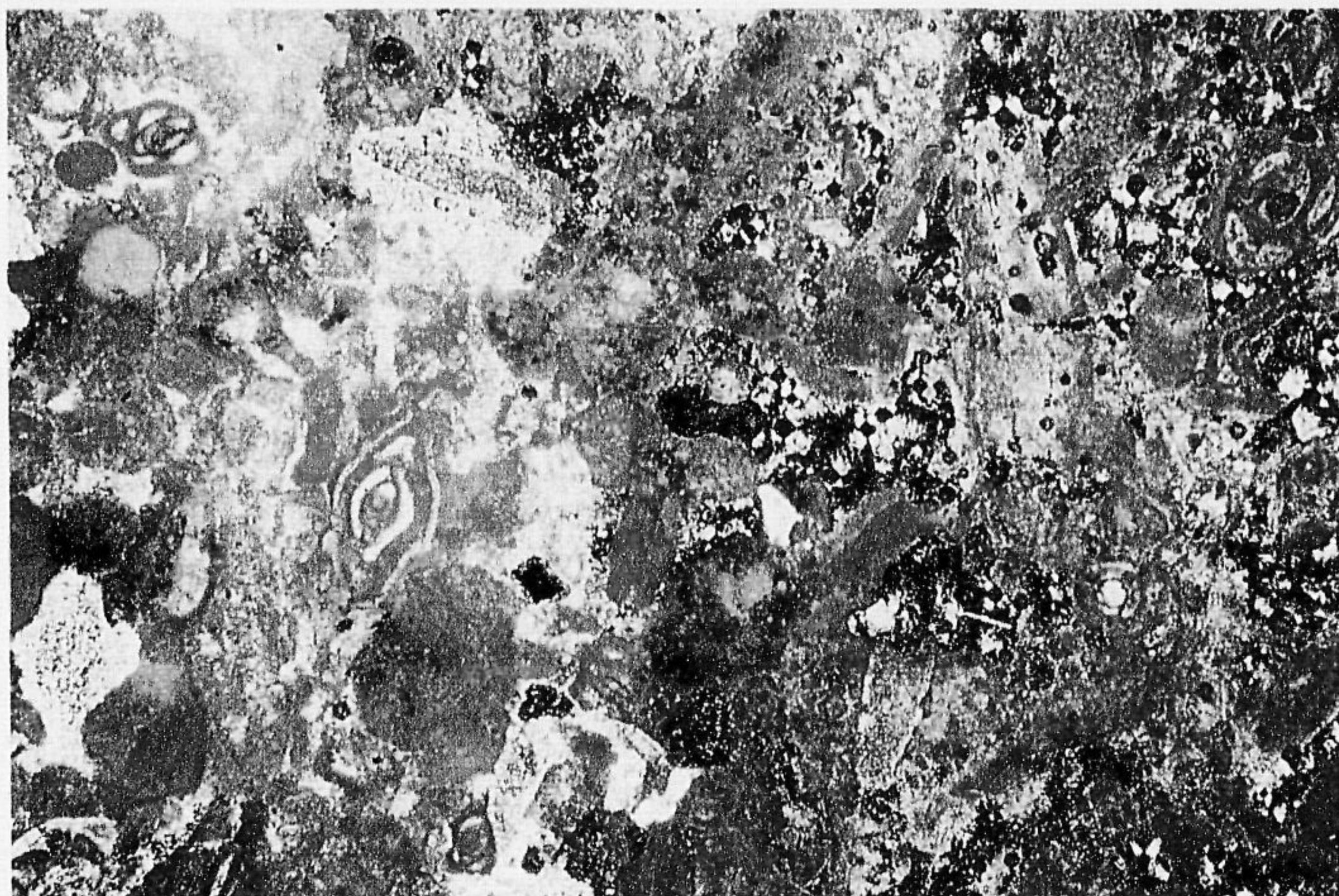
Foto 6 - Macrofotografia al microscopio polarizzatore. Nicol +. 20x Calcare organogeno. Caratteristiche strutturali della zona di ricristallizzazione (a destra) e di dissoluzione.
